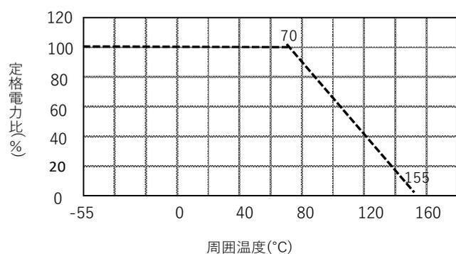
\* 定格電力は、周囲温度70°Cにおいて連続負荷出来る最大電力です。周囲温度が70°Cを超える場合は、図の負荷軽減曲線に従ってご使用ください(点線)。ただし、部品表面温度がカテゴリ温度範囲を超えないようにご注意ください。
