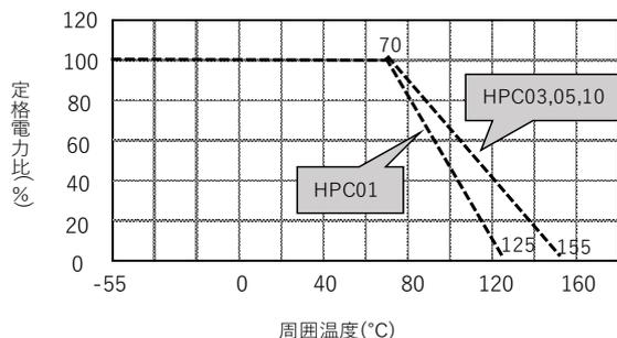
\* 定格電力は、周囲温度70°Cにおいて連続負荷出来る最大電力です。周囲温度が70°Cを超える場合は、図の負荷軽減曲線に従ってご使用ください(点線)。ただし、部品表面温度がカテゴリ温度範囲を超えないようご注意ください。
